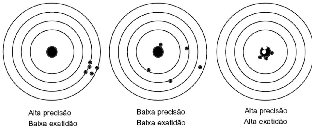
Erros aleatórios que geram flutuações nas medidas podem ter origem em diversos fatores, como condições de temperatura, pressão, iluminação, etc. Esse tipo de erro também pode ter origem no método de observação, como por exemplo se a precisão do instrumento for superestimada ao se interpolar a menor divisão da escala. Os erros aleatórios afetam a precisão das medidas e nem sempre podem ser eliminados. Esses erros, em geral, obedecem
